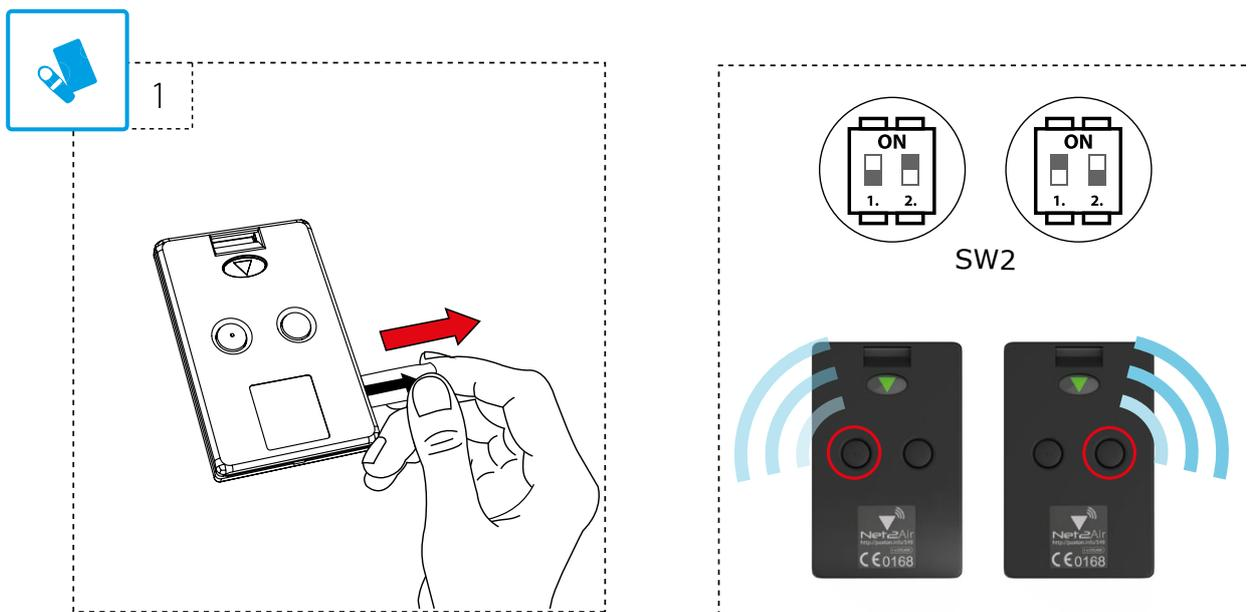
Das Handsfree-Interface verfügt über ein Paar von Switches, die mit 'SW2' beschriftet sind.
